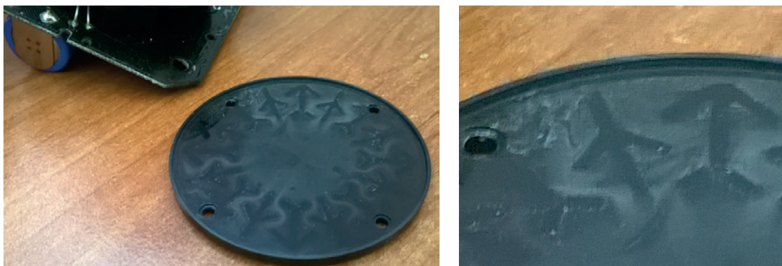
Rycina 4. Pokrywa komory czujki dymu ze śladami kurzu
