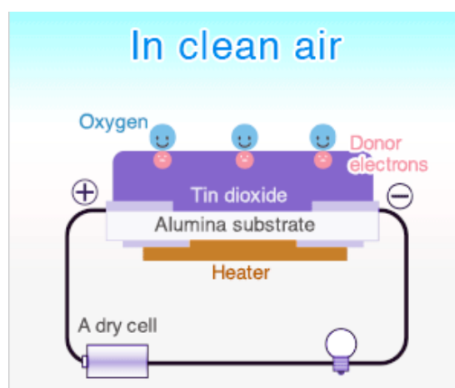
Рис. 9. Популярная демонстрация принципа работы металл-оксидного датчика [11]
