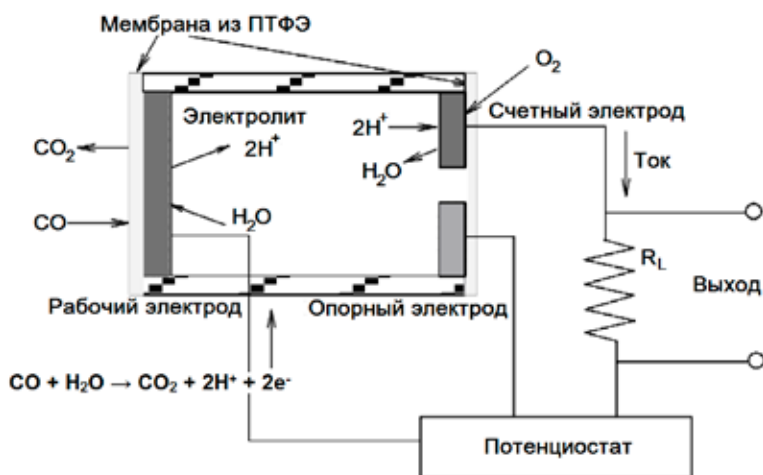
Рис. 2. Принцип действия датчика NAP-508 [10]
