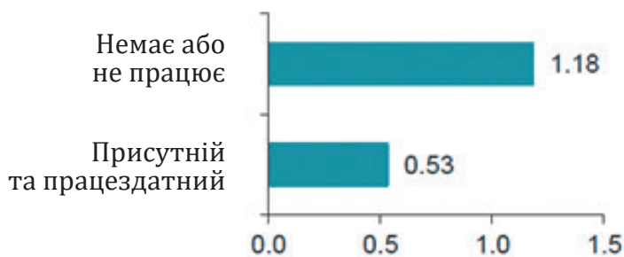
Рис. 4. Ризик загибелі людей залежно від пожежної сигналізації
